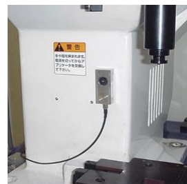
(図9) 卓上プレス機に設置したイメージ
