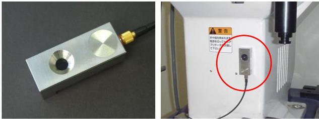
PSS 传感器通过 1 个 M6 螺栓即可固定在压着机的壳体上(加压时应变容易产生的部位)。
